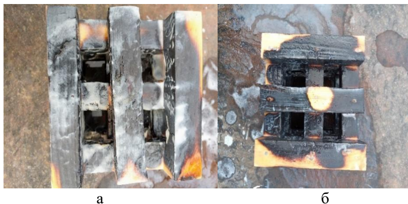
Рисунок 6 – Утворення захисної плівки після гасіння модельних вогнищ у разі застосування як вогнегасної речовини: рідкого скла та поташу (а); та рідкого скла (б)
