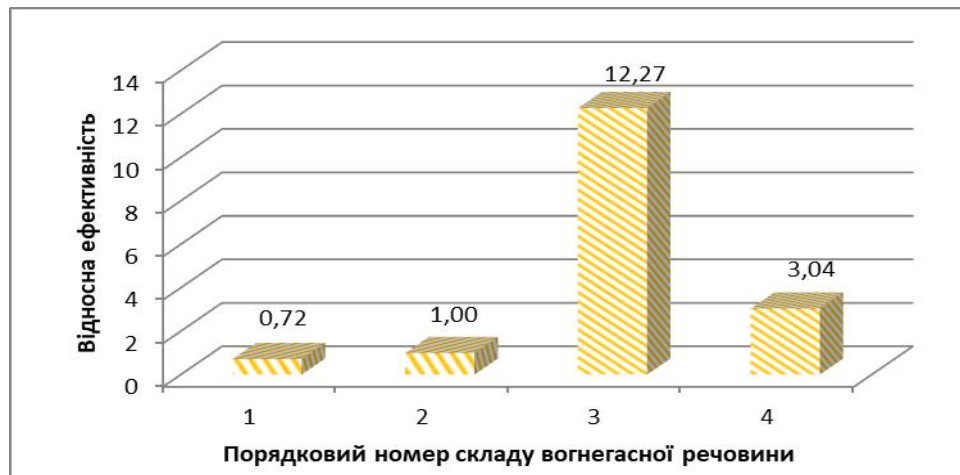
Рисунок 5 – Діаграма залежності відносної ефективності гасіння модельного вогнища від складу (згідно з нумерацією складів табл. 1) вогнегасної речовини
