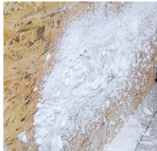
Рисунок 4 – Зовнішній вигляд компресійної піни, нанесеної на вертикальну дерев'яну (а) та пластикову (б) поверхню, після 240 секунд витримки. Співвідношення витрат водного розчину піноутворювача і повітря складало 1:12 (а) та 1:6 (б). Тиск у системі 0,5 МПа
