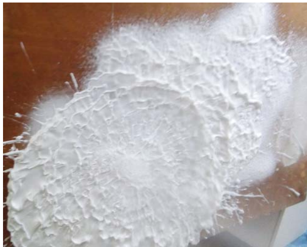
Рисунок 4 – Зовнішній вигляд компресійної піни, нанесеної на вертикальну дерев'яну (а) та пластикову (б) поверхню, після 240 секунд витримки. Співвідношення витрат водного розчину піноутворювача і повітря складало 1:12 (а) та 1:6 (б). Тиск у системі 0,5 МПа
