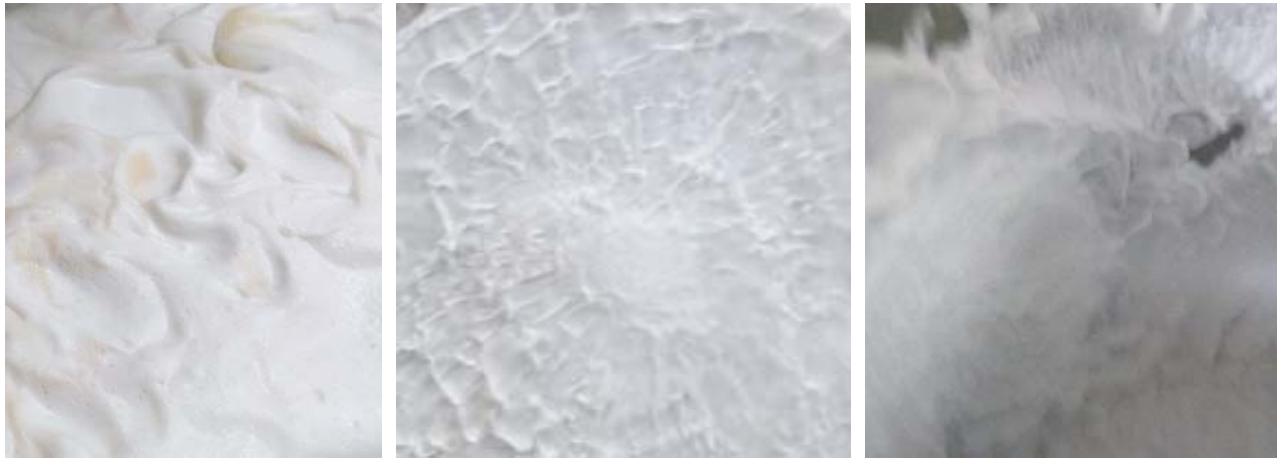
Рисунок 3 – Загальний вигляд одержаної піни за різного співвідношення витрат водного розчину ПУ і повітря: а – 1:5, б – 1:12, в – 1:20. Тиск у системі 0,5 МПа.
