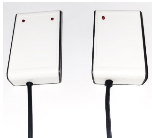
Рисунок 6 – Зовнішній вигляд трансивера та ресивера віртуальної клавіатури, змонтованих у корпуси
