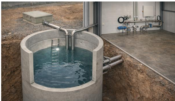
Рисунок 3 – Тривимірна візуалізація випробувального бокса архітектурно-планувального рішення бокса та конструктивні особливості заглибленої ємності
