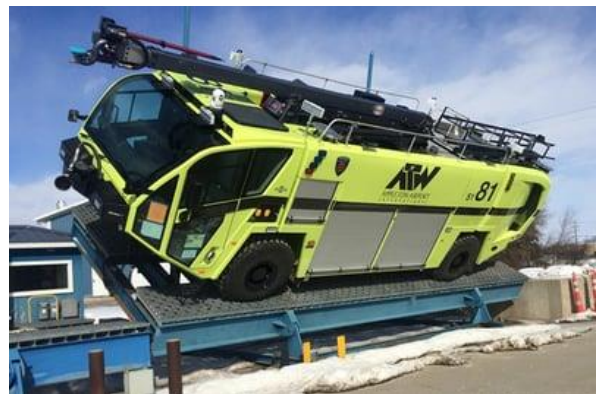
Рисунок 4 – Зовнішній вигляд стенда для визначення критичного кута нахилу техніки Джерело: [11]
