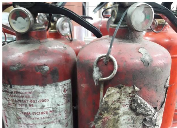
Рисунок бб – Стан вогнегасників, що надійшли на технічне обслуговування з маршрутного таксі
