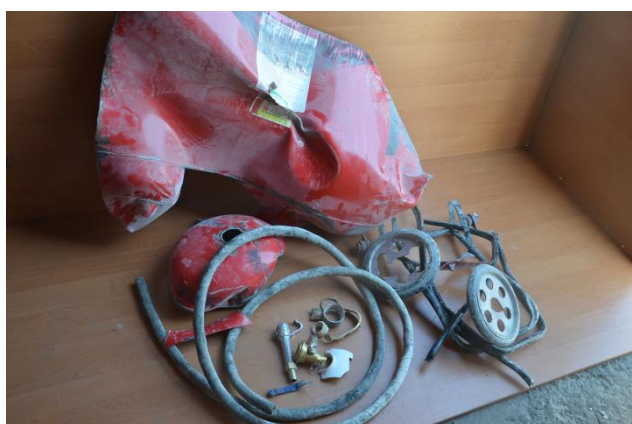
Рисунок 4а – Розривання вогнегасника ВП-50
