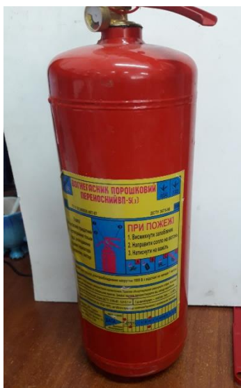
Рисунок 1а – Підроблений вогнегасник. Ознаки: Виконання корпусу не відповідає виробнику, відсутнє маркування методом клеймування корпусу вогнегасника
