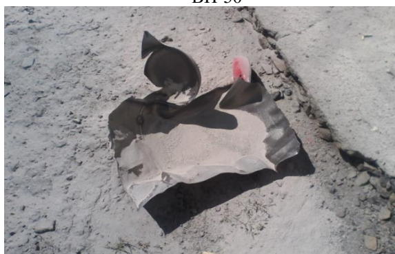
Рисунок 5б – Розривання вогнегасника у м. Миколаєві (2014 рік)
