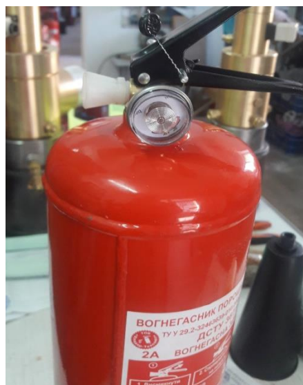
Рисунок 1б – Підроблений вогнегасник. Ознаки: Пломбування інше, інший запірно-пусковий пристрій, відсутній шланг, інший спосіб нанесення маркування на корпус
