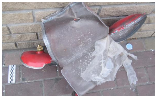
Рисунок 3б – Розривання порошкового вогнегасника, кафе «Парк Тараса Шевченка», м. Бровари (2015 рік)
