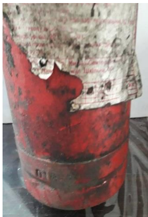
Рисунок ба – Виконання нижньої частини корпусу вогнегасника не відповідає [9]
