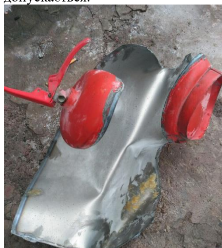
Рисунок 2а – Розривання підробленого корпусу вогнегасника. Зварювальні шви не відповідають вимогам НД (2018 рік)
