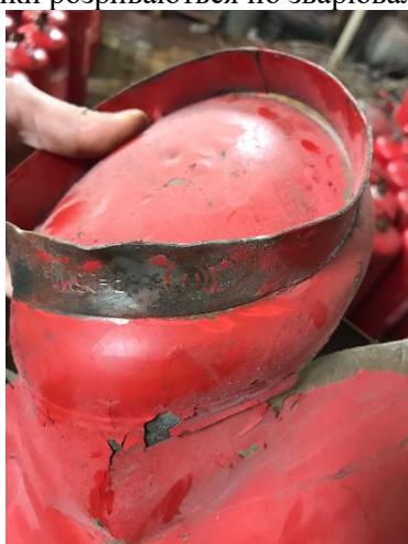
Рисунок 2а – Розривання підробленого корпусу вогнегасника. Зварювальні шви не відповідають вимогам НД (2018 рік)
