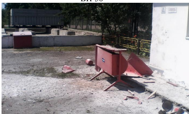
Рисунок 5а – Розривання вогнегасника у м. Миколаєві (2014 рік)
