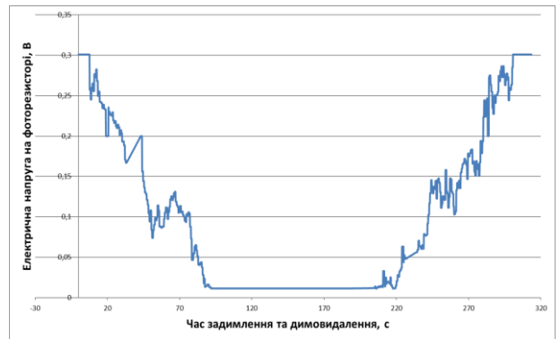
Рисунок 6 – Результати експериментальних досліджень з визначення коефіцієнту ефективного зменшення задимленості під час нагнітання повітря з одночасним подаванням розпиленого струменю води до випробувального боксу за допомогою ПЗДТ
