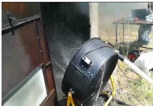
Рисунок 3 – Робочі моменти проведення експериментальних досліджень з визначення коефіцієнту ефективного зменшення задимленості
