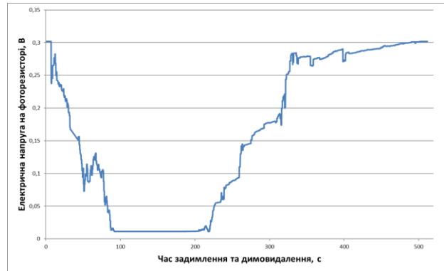
Рисунок 5 – Результати експериментальних досліджень з визначення коефіцієнту ефективного зменшення задимленості під час нагнітання повітря до випробувального боксу за допомогою ПЗДТ
