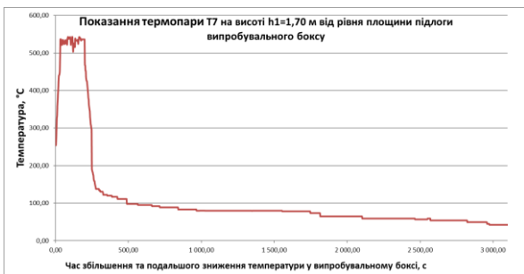
Рисунок 9 – Результати експериментальних досліджень з визначення часу самостійного зниження температури
