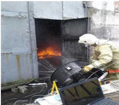
Рисунок 8 – Робочі моменти проведення експериментальних досліджень з визначення коефіцієнту ефективного зниження температури Результати експериментальних досліджень з визначення часу самостійного зниження температури наведено на рисунку 9.
