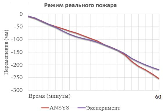
Рисунок 10 – Прогин в середині прольоту залізобетонної плити при температурному режимі реального пожеги
