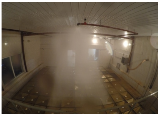
Рисунок 9 – Загальний вид форми розпилювання води зі зрошувача за вертикальної його орієнтації у просторі та робочого тиску 8 бар: а) – вид спереду; б) – вид збоку
