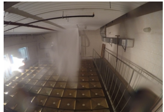
Рисунок 9 – Загальний вид форми розпилювання води зі зрошувача за вертикальної його орієнтації у просторі та робочого тиску 8 бар: а) – вид спереду; б) – вид збоку
