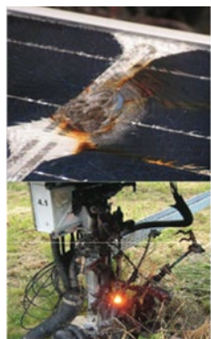
Рисунок 5 – Гасіння пожежі на фотогальванічній системі, змонтованій на житловому будинку, та виникнення контактної пожежі
