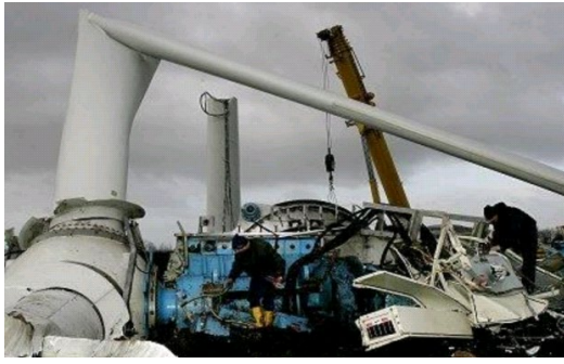
Рисунок 8 – Руйнування вежі ВЕУ біля автобана внаслідок екстремального вітру
